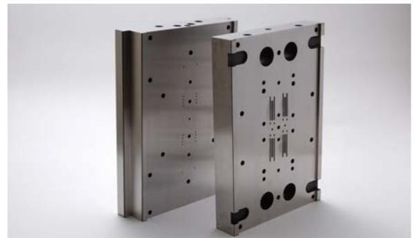
**熱処理** 焼き入れ高温焼き戻し2回 サブゼロ処理
